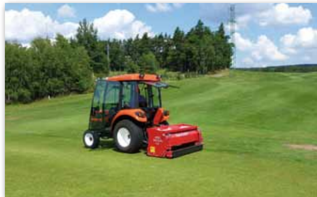
Rozteč nožů od 5 až po 30 cm dle použité hřídele
