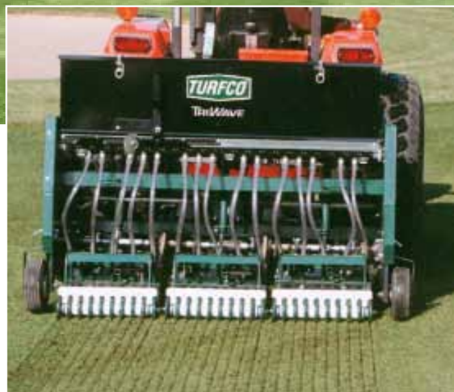
TriWave 60" – verze za traktor s pohonem od vývodového hřídele
