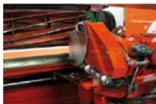
Patentovaný systém autoindexace při broušení podbrusu
