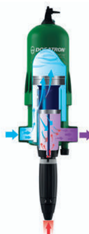
řez čerpadlem - schéma funkce
