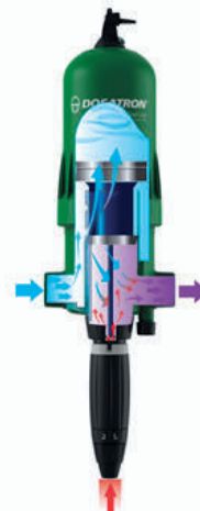
řez čerpadlem - schéma funkce
