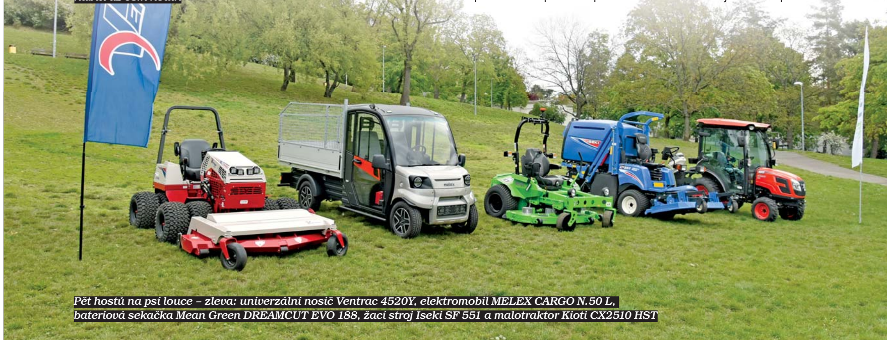
Profesionální elektrická sekačka Mean Green DREAMCUT EVO 188 s nulovým poloměrem otáčení a záběrem 1,88 m pracuje na jedno nabití až osm hodin
