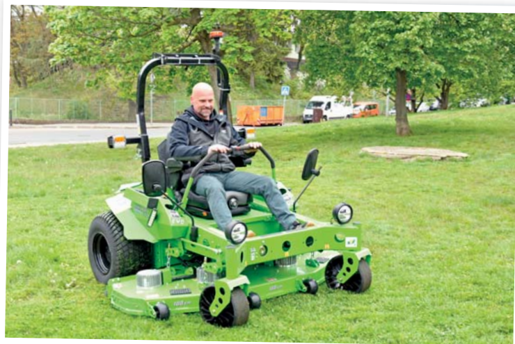
Profesionální elektrická sekačka Mean Green DREAMCUT EVO 188 s nulovým poloměrem otáčení a záběrem 1,88 m pracuje na jedno nabití až osm hodin
