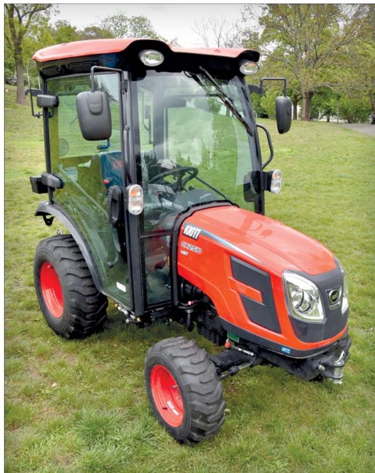
Malotraktor Kioti CX2510 HST se díky průjezdné šířce zhruba 1,2 m dobře uplatní při práci v prostorově omezených místech, například na úzkých chodnících
